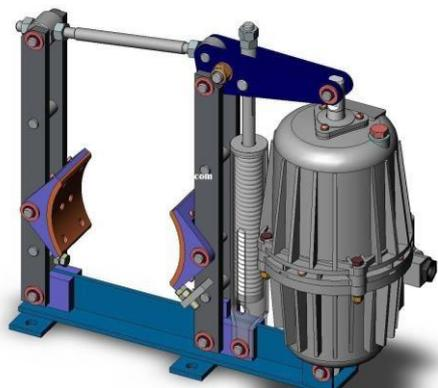
Широкое применение в различных отраслях промышленности нашел тормоз колодочный ТКК. Свою задачу тормоз колодочный ТКК выполняет в механизмах, имеющих крутящиеся валы. Тормоз колодочный ТКК служит для остановки и удержания в нужном положении данных валов. Конструктивно тормоз колодочный состоит из механических составляющих и электрогидравлического привода, для управления усилиями в различных режимах работы.
