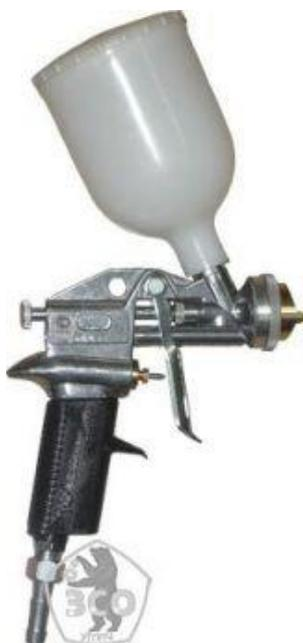
**Ручной пневматический краскораспылитель СО-71В (краскопульт пневматический)** предназначен для выполнения окрасочных работ методом распыления ЛКМ сжатым воздухом с вязкостью краски не более 50с. Применяется для выполнения всевозможных окрасочных работ, а также для нанесения различных антикоррозийных покрытий (пропитки и защиты древесины, консервации машин, узлов и деталей, и т.п.). Краскораспылитель СО-71В может работать как от верхнего наливного бачка, так и от нагнетательного бака.
