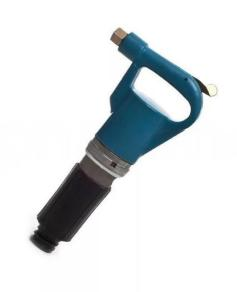
МР-22 - пневматическое ручное оборудование для рубки металлических материалов, заготовок и изделий средней толщины, зачистки сварных стыков, постановки заклепок, устройства отверстий и пр. Конструкция рубильного молотка включает ударный узел, корпус-рукоятку с механизмом управления, встроенные системы вибрационной защиты. Мощность 22 Дж при единичном ударе: этого вполне достаточно для использования модели на промышленных предприятиях, преимущественно в металлургической отрасли.
